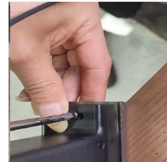
2. Протяните кабель ретрактора, чтобы он прошел через шину, затем совместите направление кронштейна (1) и ретрактора (2) с направлением кабеля (3), затем зафиксируйте кронштейн под столом.
