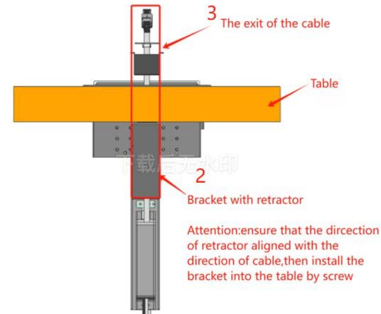
3. С помощью 8 винтов M4×12, зафиксируйте кронштейн с ретрактором под столом.
