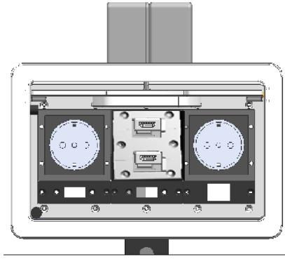
2. Установка 4 ретракторов WRTS-HDMI120-RT/ WRTS-USBCV-RT в лючок WRTS-12BOX
