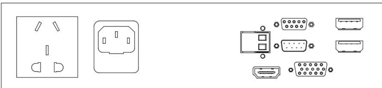
1.3.1 AC 220 В выходная розетка для создания контура питания (максимально 10 устройств в цепи).
