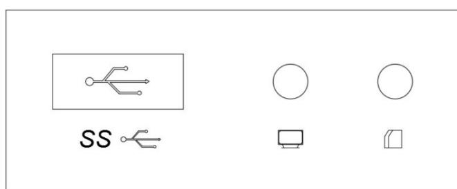
Слот с USB разъемом предназначен для подключения флэш накопителей к удаленному ПК.
