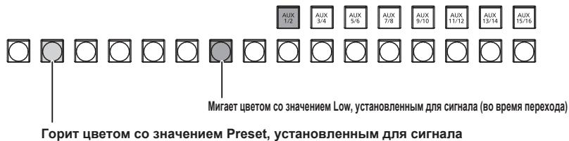
Если для параметров с [AUX1] по [AUX4] установлено значение [On] в столбце [AUX Trans], выберите сигнал источника, который изменяется с помощью соответствующих кнопок переключения шины KEY.
