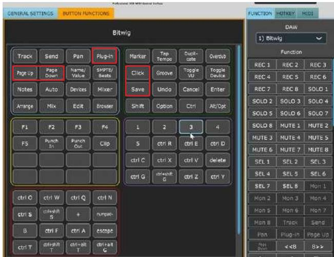
Это отображается на сенсорном экране P1-M. Все настройки функций на втором экране (функции кнопок) в iMAP будут соответствовать настройкам на P1-M. Другими словами, то, что отображается на втором главном экране iMAP, будет отображаться и на P1-M. Любые изменения будут применены мгновенно.
