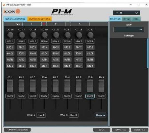
Интеллектуальная конструкция нового, высокопроизводительного iMap позволяет пользователям вносить изменения в режиме реального времени — без необходимости «отправлять данные». Пользователи могут загрузить три DAW по своему выбору с помощью трёх кнопок в верхней части iMap.
