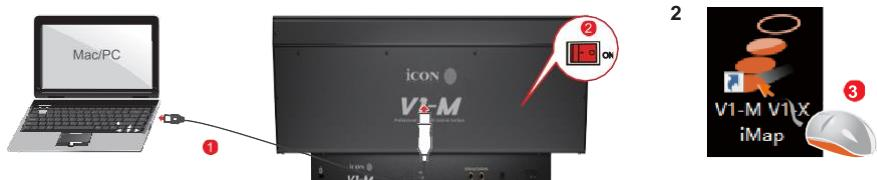
**Внимание:** Процесс загрузки прошивки ДОЛЖЕН быть завершен и не прерываться во время загрузки файла, в противном случае прошивка не сможет быть перезаписана.
