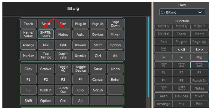
Вы также можете назначить функции через список функций под выпадающим списком DAW. Просто щелкните место, где должна отображаться функция (A), и выберите функцию (B).
