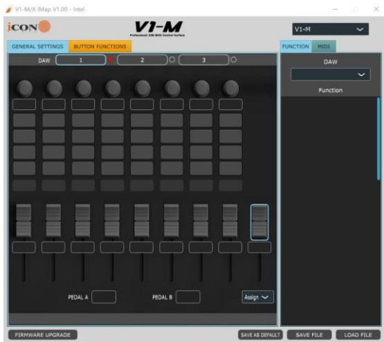
Интеллектуальная конструкция нового, высокотехнологичного iMap позволяет пользователям вносить изменения в режиме реального времени. Пользователи могут загрузить три DAW по своему выбору с помощью трёх кнопок в верхней части iMAP.
