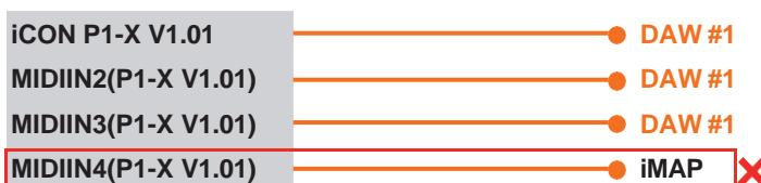
*Примечание: MIDI-порт 4 используется программным обеспечением iCON Pro Audio, iMAP™, для смены трех используемых вами DAW, обновления прошивки и программирования 16-панельного сенсорного экрана с функциями по вашему выбору.*
