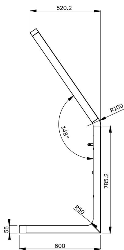
**СХЕМА ДИСПЛЕЯ (ВИД СЗАДИ)**
